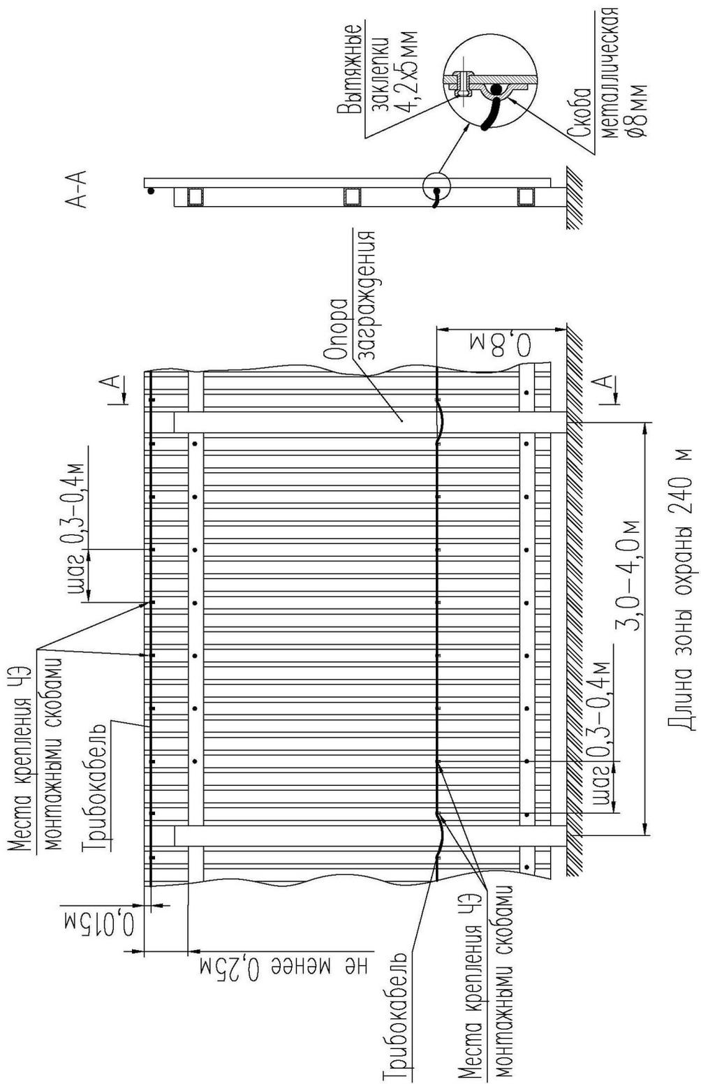
Рисунок А.4.3 - Заграждение из цельных металлических листов без нажимного козырька
