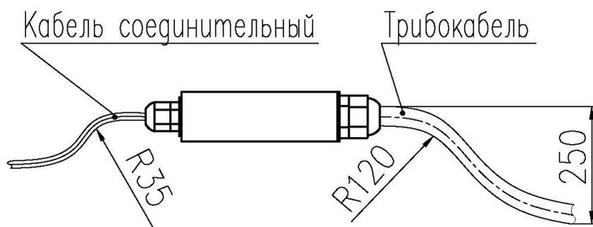
Рисунок А.14.1 - Пример установки муфты переходной и муфты соединительной
