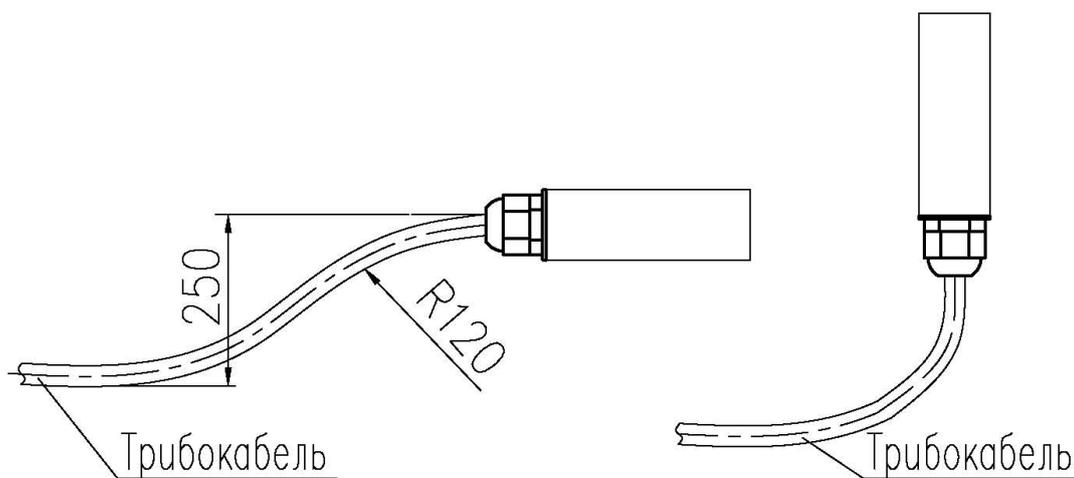
Рисунок А.14.2 - Примеры установки устройства окончного
