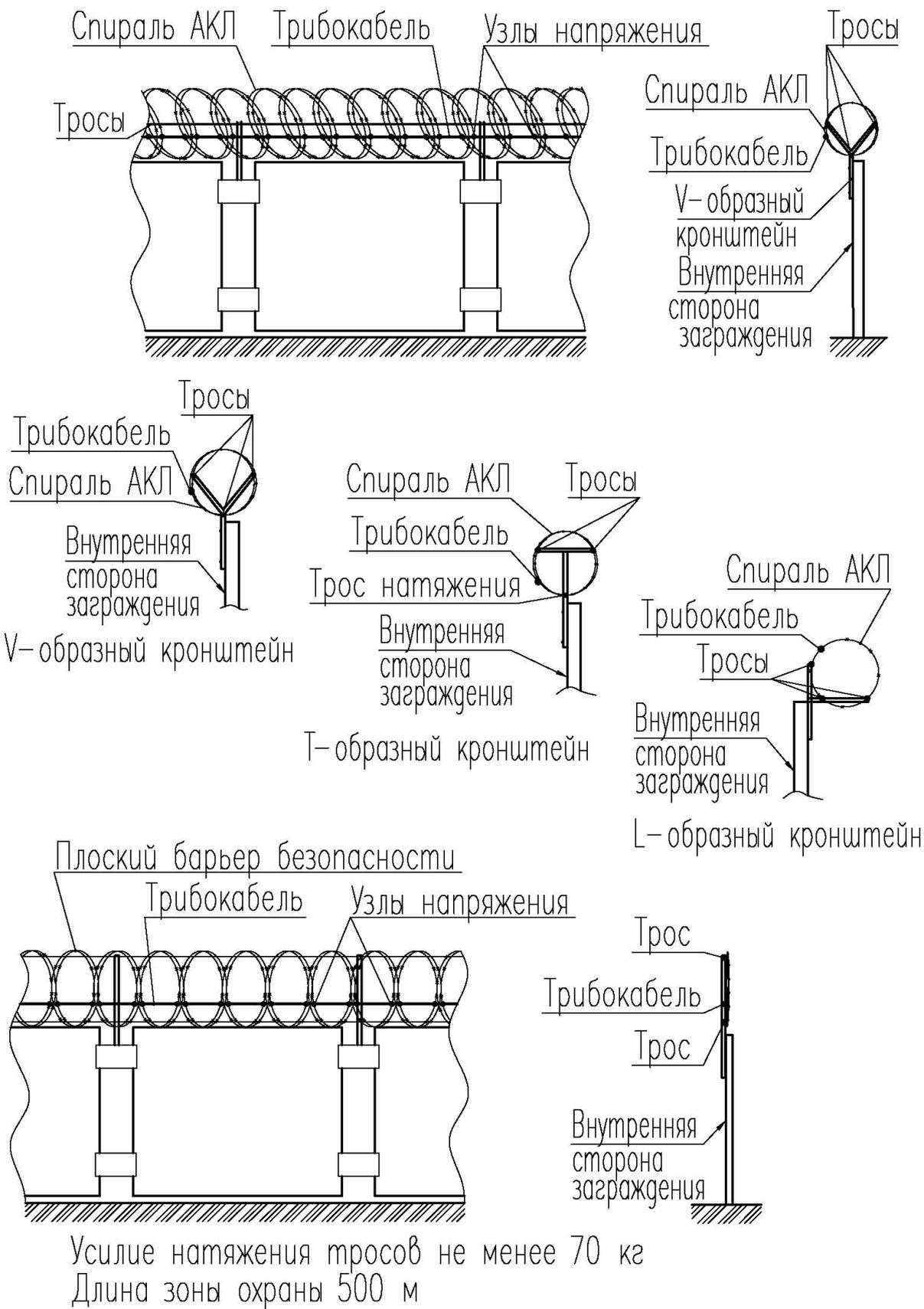
Рисунок А.5.3 - Дополнительное заграждение из спирали АКЛ
