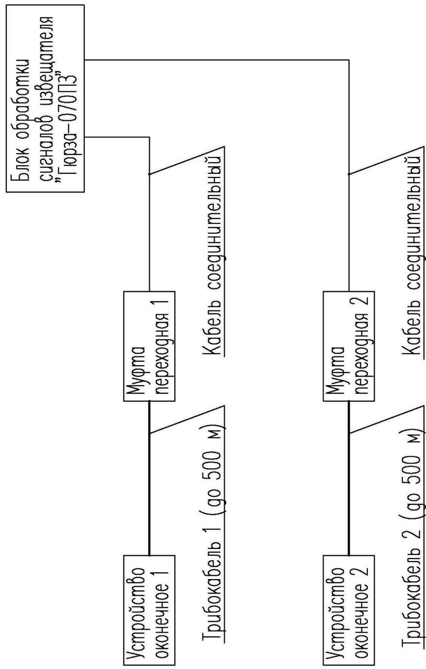
Рисунок А.3 - Оборудование гибких заграждений
