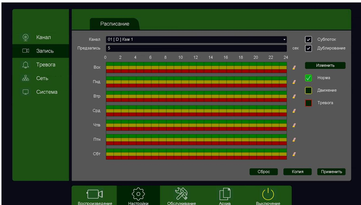
**Субпоток** – запись не только основного видеопотока с камеры, но и субпотока. При включении данной настройки возможно отображение до 16 камер в архиве.
