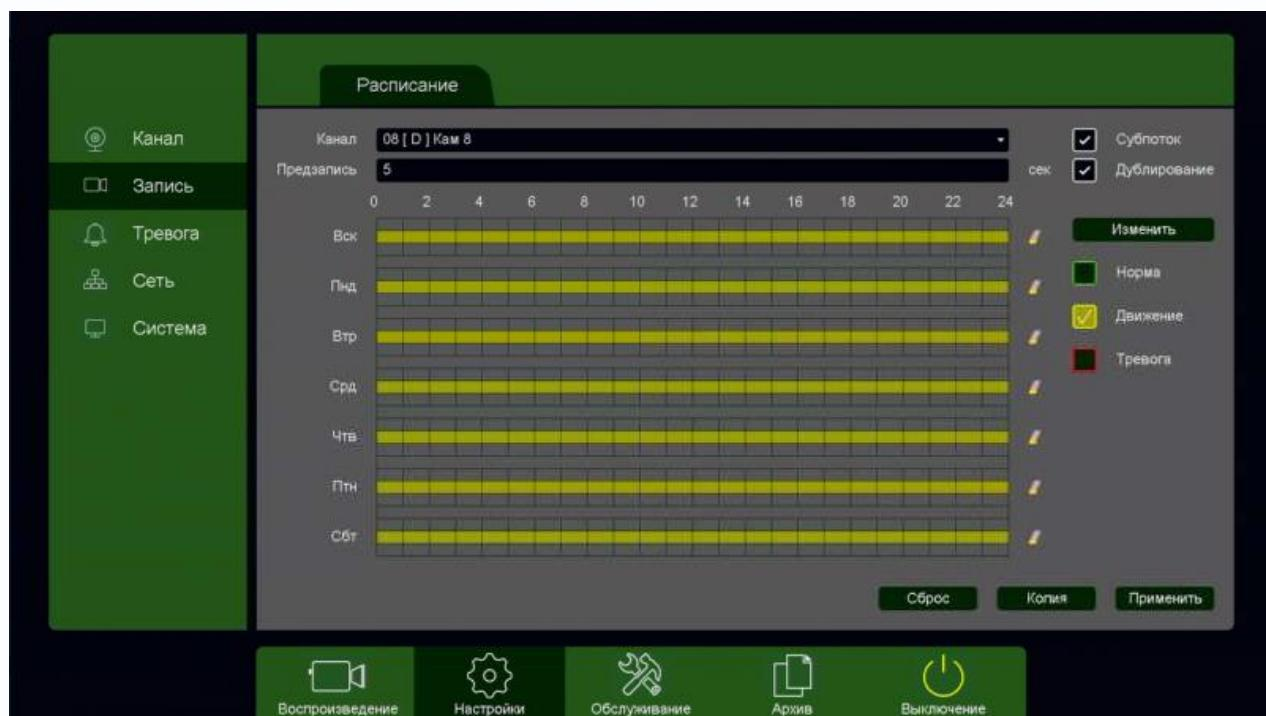
Постоянная запись по расписанию на FTP возможна, но так как длина файлов записи при записи по расписанию не регулируется, то невозможно предсказать момент начала синхронизации и записи на FTP (регулировка длины записи файлов при непрерывной записи будет добавлена в новых версиях прошивки).
