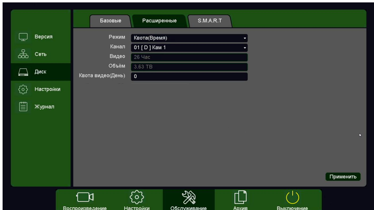
Разнообразие режимов записи камер позволяет гибко управлять политикой записи, например, часть камер может иметь большую глубину записи архива, а часть камер может иметь малую глубину записи архива.
