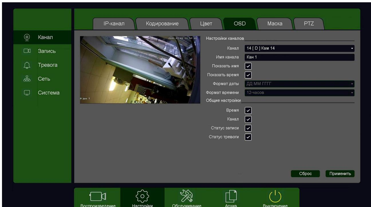
**Канал** – канал регистратора, к которому подключена камера.
