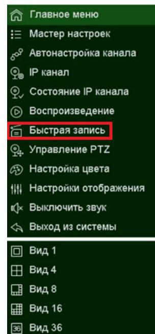
Для включения записи необходимо выбрать **Вручную** и нажать **OK**. Для отключения ручной записи нужно выбрать **Отключено** и нажать **OK**.
