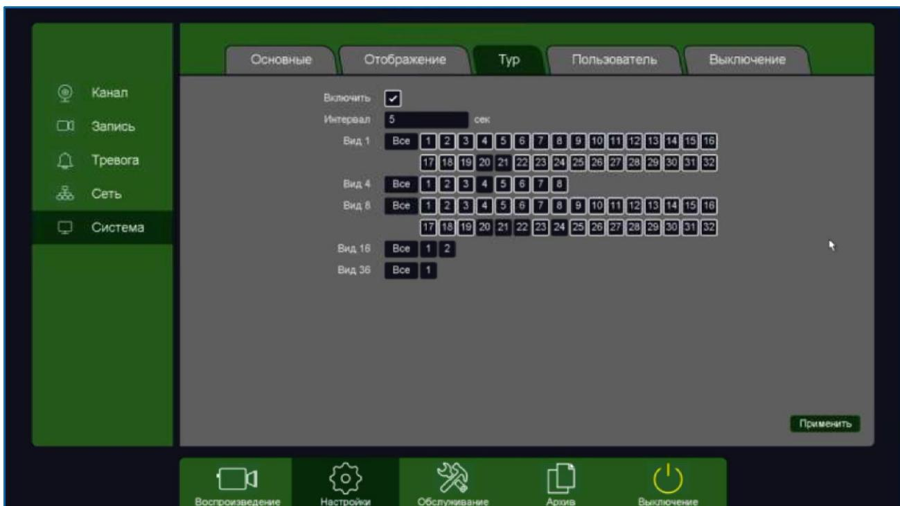
В данном меню можно настроить автоматическую смену через заданный интервал шаблона отображения на мониторе и выбрать отображаемые на данных шаблонах камеры.
