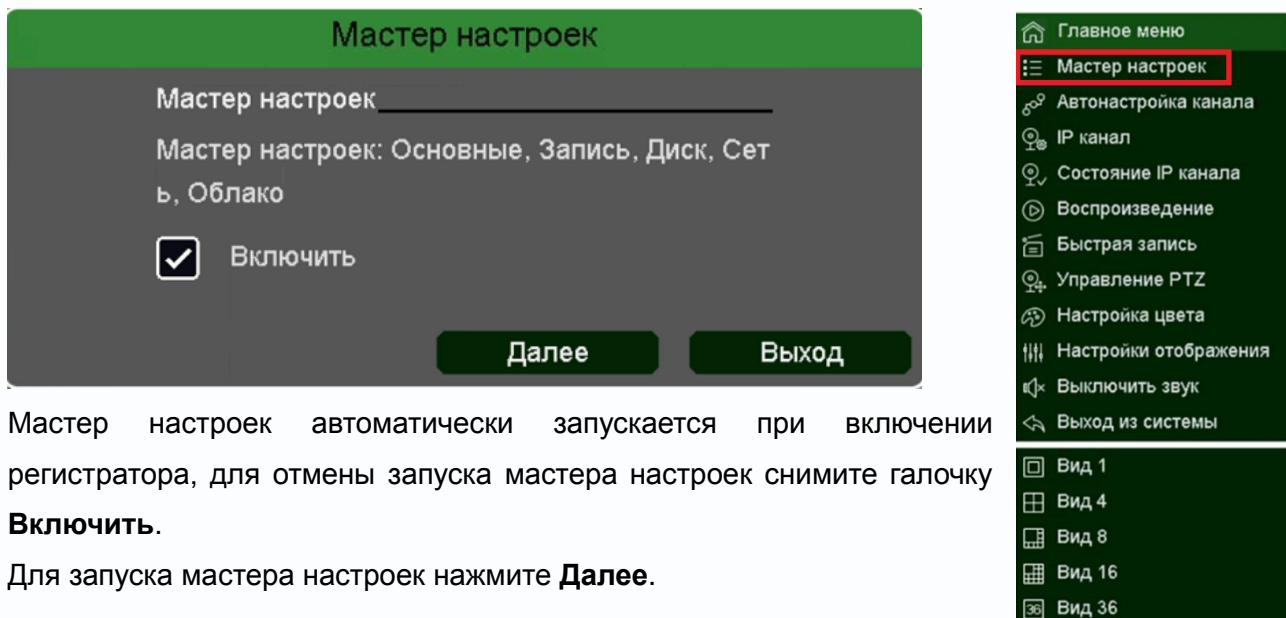
Мастер настроек автоматически запускается при включении регистратора, для отмены запуска мастера настроек снимите галочку **Включить**.
