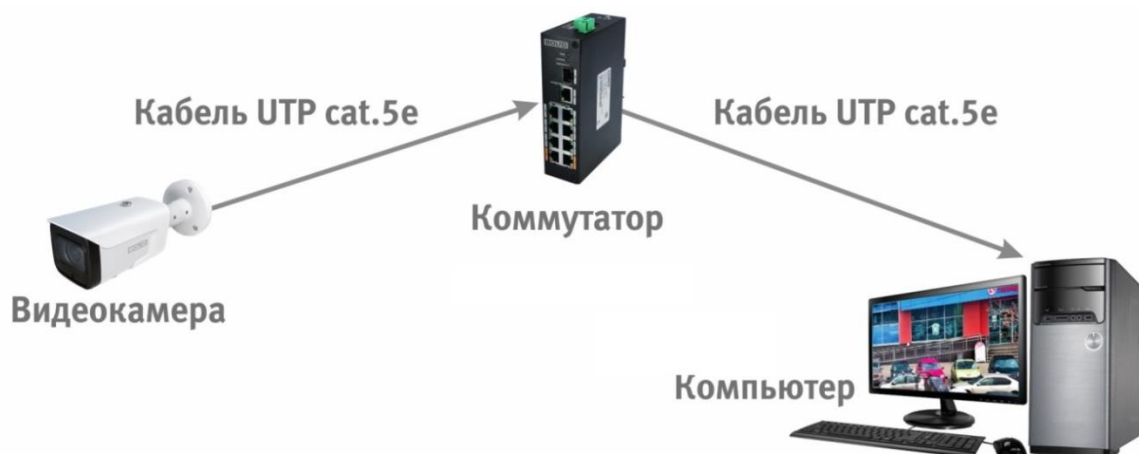
Рисунок 6.3 – Схема подключения видеокамеры к компьютеру через коммутатор
