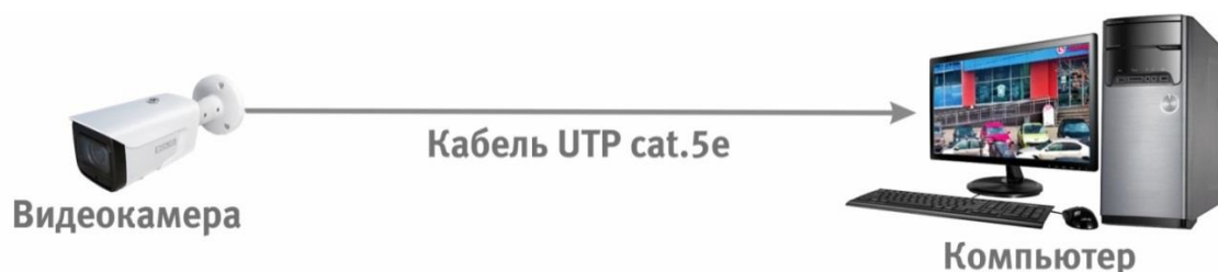
Рисунок 6.2 – Схема подключения видеокамеры к компьютеру
