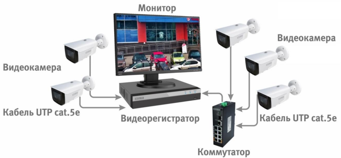
Рисунок 6.4 – Схема подключения видеокамеры к видеорегистратору
