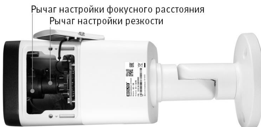
Рисунок 5.14 — Настройка фокусного расстояния и резкости
