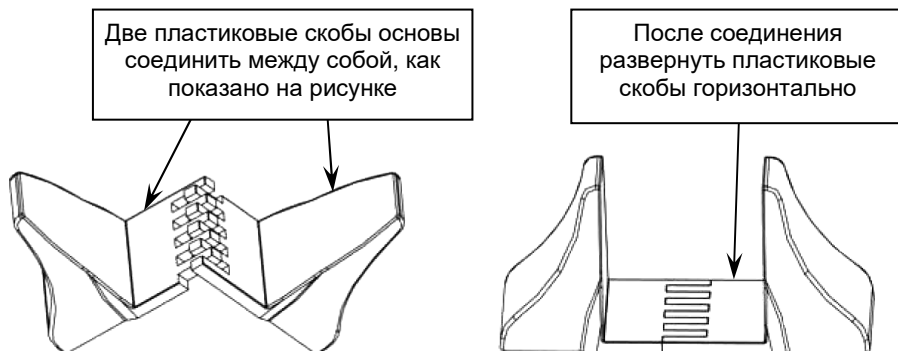
Рисунок 3 – Сборка пластиковых основ для вертикальной установки изделия
