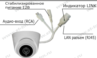
Рис. 1 Схема подключения видеокамеры
