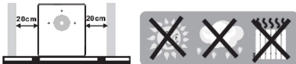
Figure 1. Posizionamento dell' UPS
